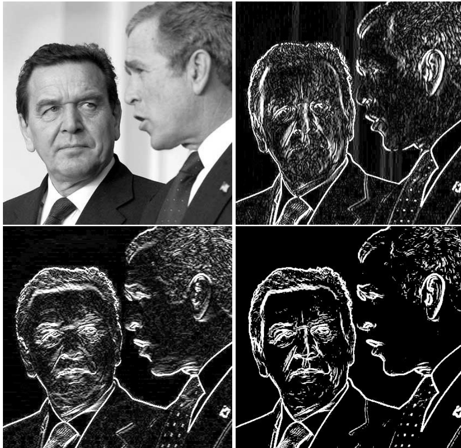
Abbildung 4: Anwendung des Sobel Operators. (oben links) Originalbild (oben rechts) Ergebnis des “vertikalen” Sobel Operators (unten links) Ergebnis des “horizontalen” Sobel Operators (unten rechts) Kombination der beiden Ergebnisse nach Anwendung eines Thresholds.
