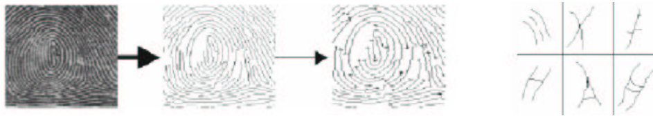
Abbildung 2: Zwischenschritte bei der Analyse eines Fingerabdruckes. Ziel ist es, die Position der rechts dargestellten markanten “Features” zu finden und mit einer Datenbank zu vergleichen. (Herkunft unbekannt)
