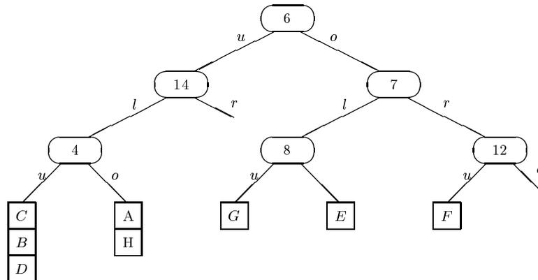
Abbildung 5.4: 2-d-Baum (inhomogen) zu den Datenpunkten A,B,C,D,E,F,G,H
