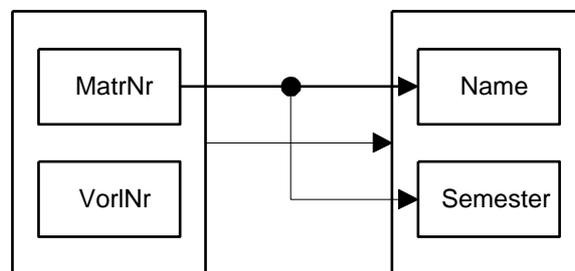
Abbildung 11.1: Graphische Darstellung der funktionalen Abhängigkeiten von *StudentenBelegung*
