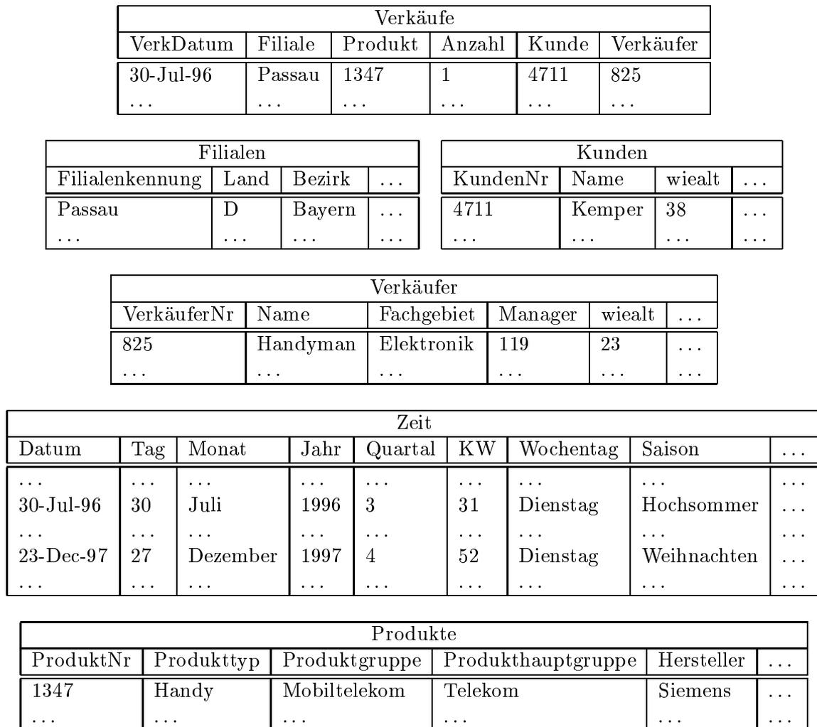
Abbildung 17.3: Ausprägung des Sternschemas in einem Handelsunternehmen
