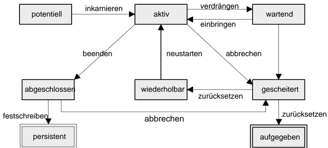
Abbildung 12.1: Zustandsübergangsdiagramm für Transaktionen
