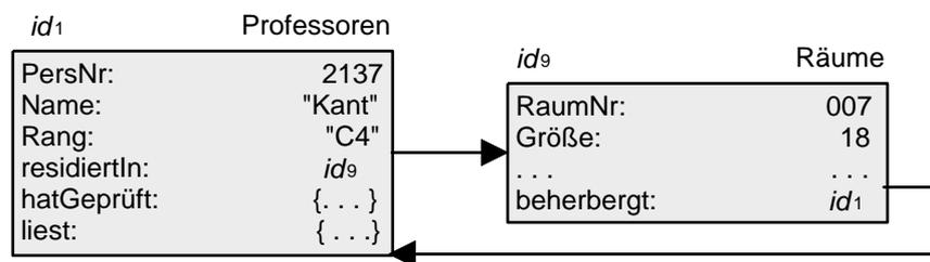
Abbildung 16.4: Ausprägung einer 1:1-Beziehung
