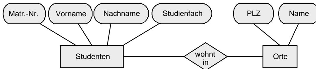
Abbildung 1.4: Beispiel für E-R-Diagramm
