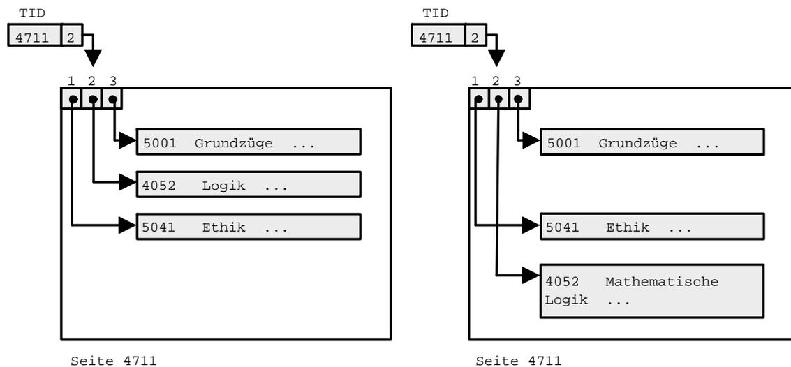
Abbildung 4.1: Verschieben eines Tupels innerhalb einer Seite
