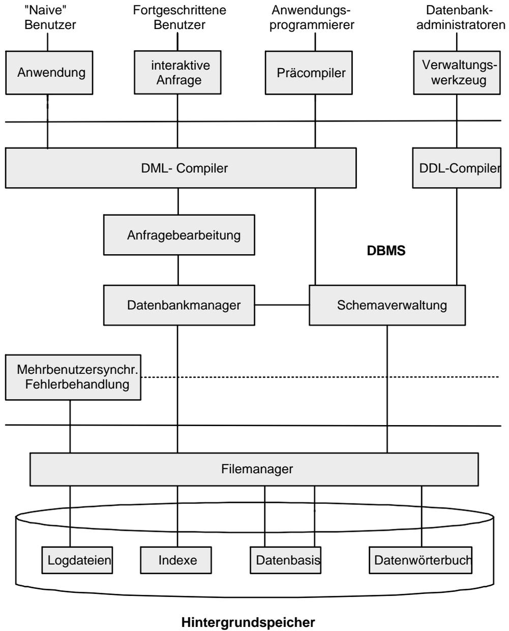
Abbildung 1.5: Architektur eines DBMS
