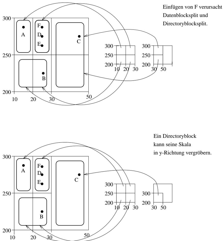
Abbildung 5.12: Vergrößerung des Grid Directory nach Aufspalten
