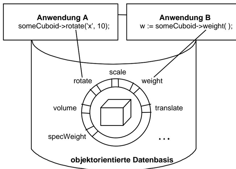
Abbildung 16.2: Visualisierung der Vorteile der objektorientierten Datenmodellierung
