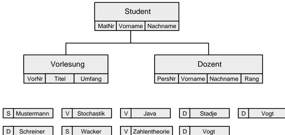
Abbildung 3.1: Hierarchisches Schema und eine Ausprägung.
