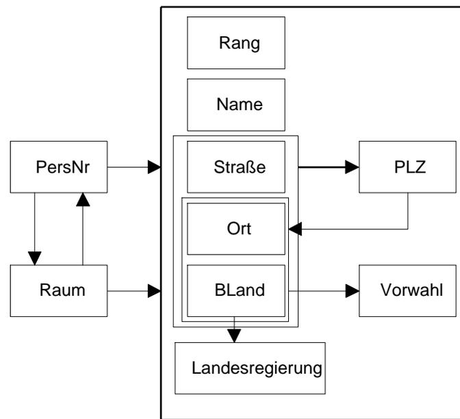
Abbildung 11.2: Graphische Darstellung der funktionalen Abhängigkeiten von ProfessorenAdr
