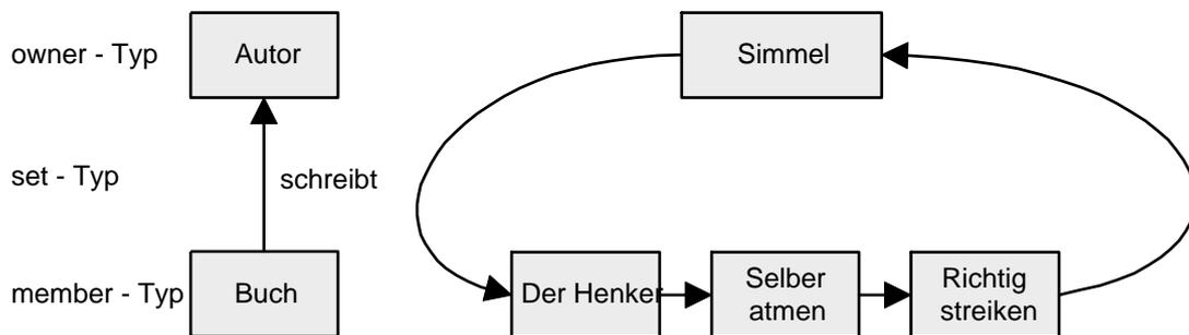
Abbildung 3.4: Netzwerkschema und eine Ausprägung
