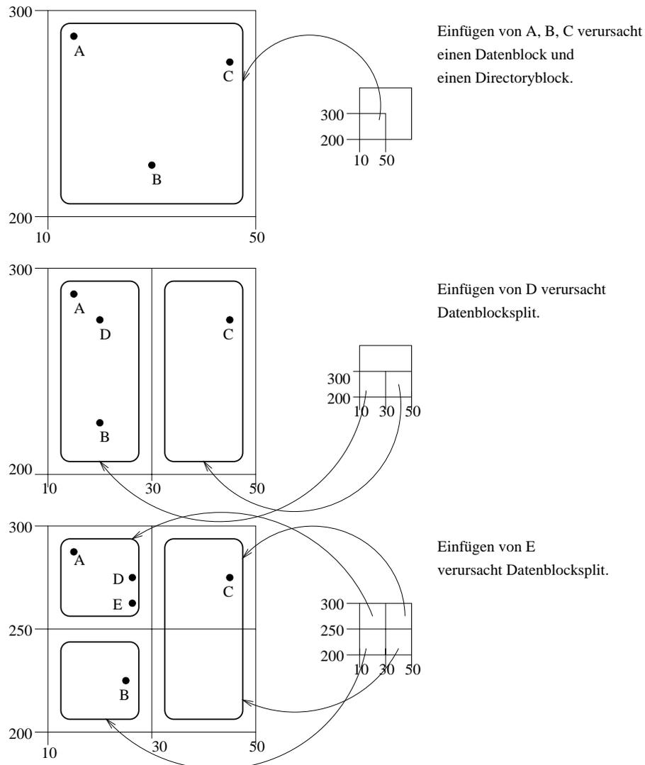
Abbildung 5.11: Dynamik des Grid File beim Einfügen der Datenpunkte A,B,C,D,E
