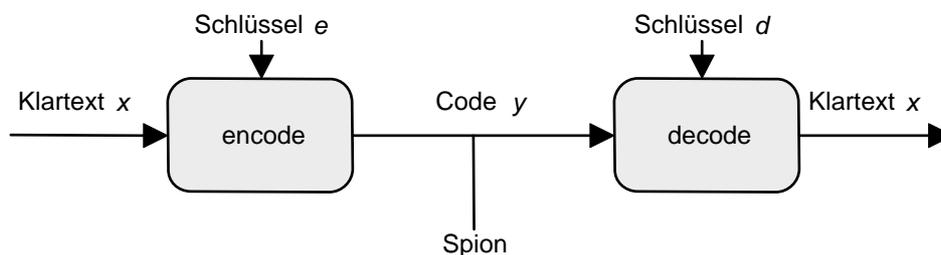
Abbildung 15.2: Ablauf beim Übertragen einer Nachricht
