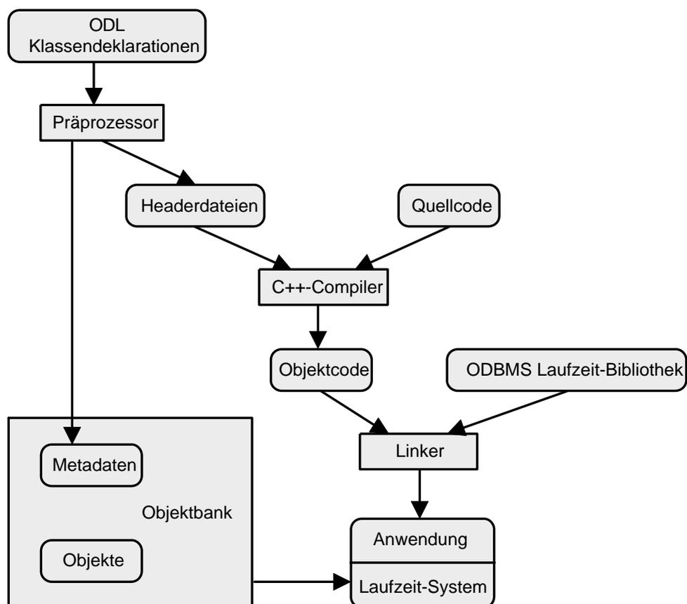
Abbildung 16.15: C++-Einbindung
